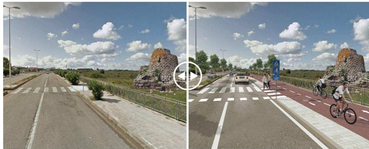
FIGURA 36 INSERIMENTO PISTA IN SEDE PROPRIA BIDIREZIONALE AFFIANCATA AL MARCIAPIEDE
