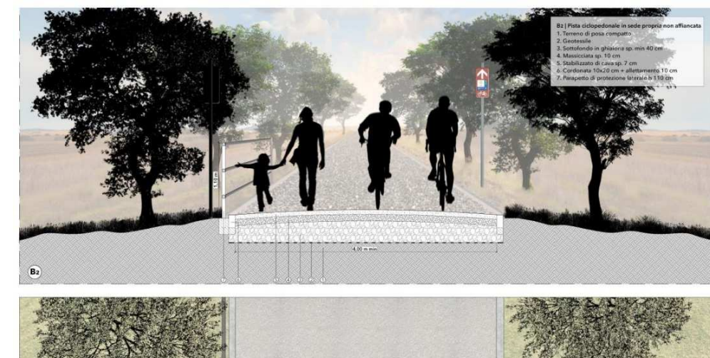
FIGURA 47 DETTAGLIO COSTRUTTIVO PISTA IN SEDE PROPRIA BIDIREZIONALE NON AFFIANCATA CICLOPEDONALE CON PAVIMENTAZIONE IN STABILIZZATO MISTO CAVA
