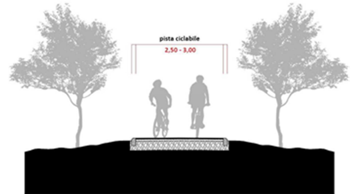
FIGURA 45 DETTAGLIO COSTRUTTIVO PISTA CICLABILE BIDIREZIONALE SEDE PROPRIA NON AFFIANCATA
