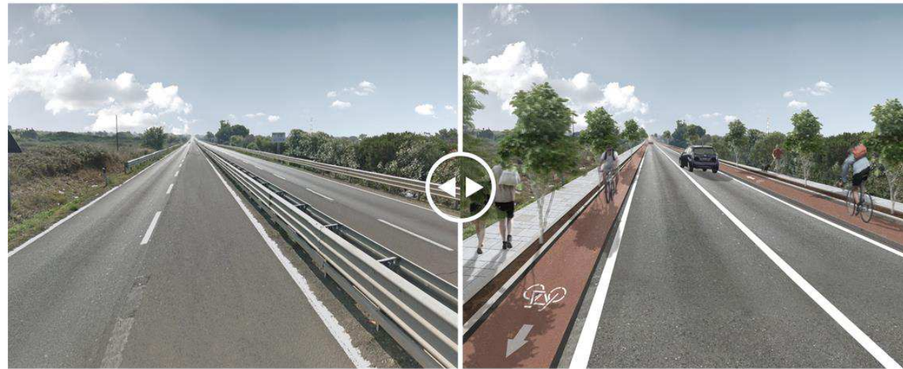
FIGURA 35 INSERIMENTO PISTA IN SEDE PROPRIA MONODIREZIONALE AFFIANCATA AL MARCIAPIEDE
